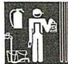
Aufstellung eines Brandpostens mit geeignetem Löschgerät für die Arbeitsstelle
